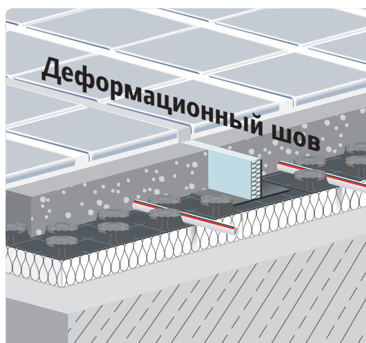
Конструктивное оформление деформационного шва (пример: Upronor Tecto)
